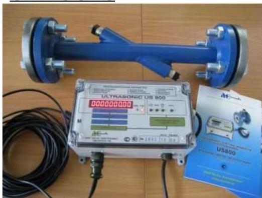
Рисунок 6 - Расходомер US800 Ультразвуковой расходомер US800 предназначен для измерения и учета текущего расхода и накопления объема жидкости (температурой до 200°C), протекающей под давлением в трубопроводе диаметром от 15 до 2000 мм на станции 1 и 2 подъема.
